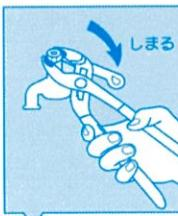
新しいハンドルを取り付けます。ハンドルをかぶせて「ソフトタッチウォータ」で、ビスを締めれば完了です。
