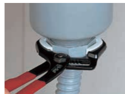
角型に付け替えると大きなプラスチックナットをしっかりとつかむ。
