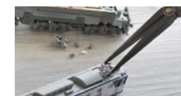
PNS-ism プロニードルストレート 極細な先端部で狭い場所での精密作業に。
