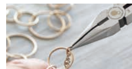
PNP-115G プロニードルペンチ 極細の先端部で精密な曲げ作業と切断が可能。 切断能力:軟鉄φ1.0 銅線φ1.5位まで
